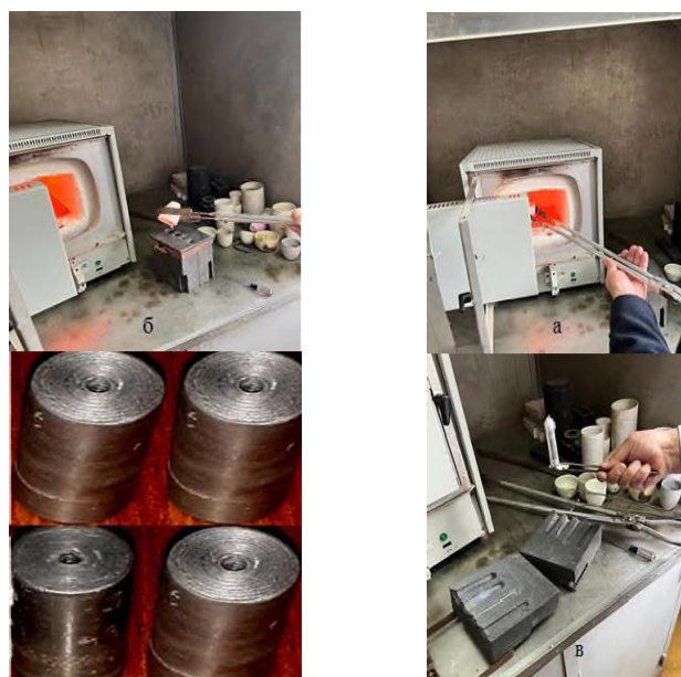
Рисунок 1. Процесс получения сплавов: а-плавление шихты в муфельной печи, б-литьё образца в графитовой изложнице, в-извлечение образца из изложницы, г-готовые образцы для исследования
