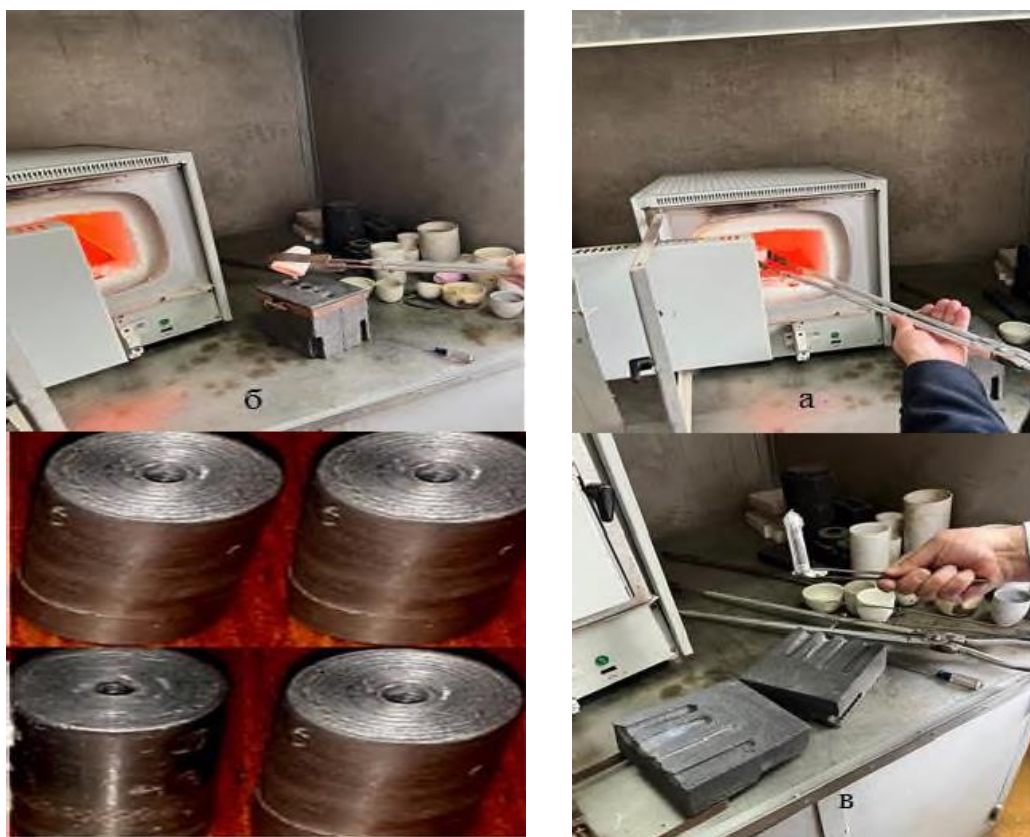
Рисунок 1 –Процесс получения сплавов: а-плавление шихты в муфельной печи, б-литьё образца в графитовой изложнице, в-извлечение образца из изложницы, г-готовые образцы для исследования
