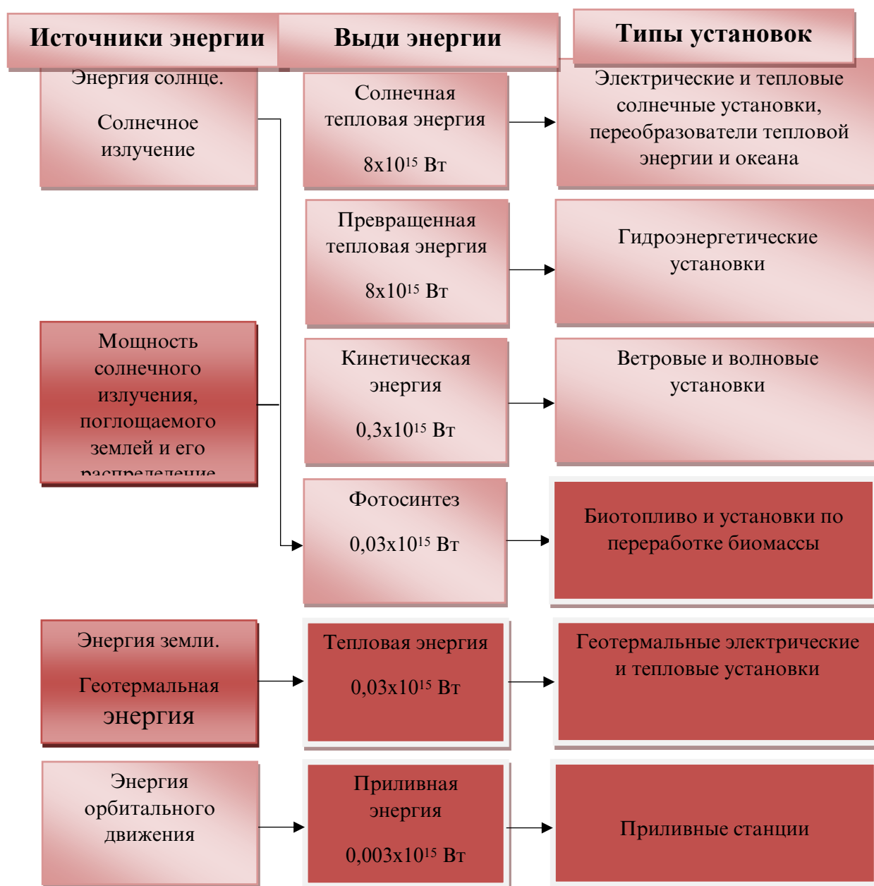
Рис. 1. Потенциальные мощности возобновляемых источников энергии по видам, направления их использования, а также типы энергетических установок.
